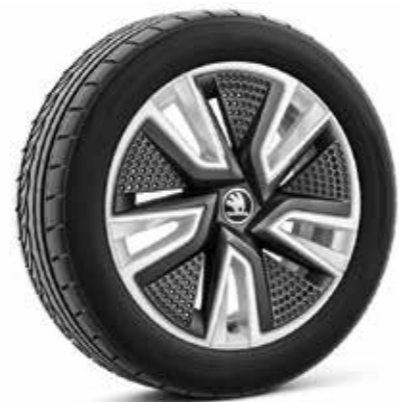
Kola z lehké slitiny PROXIMA 16" (stříbrná, černé Aero kryty) 6J × 16", ET45, 195 / 55 R16
