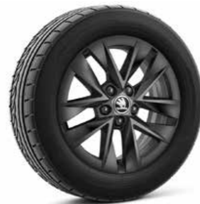
Kola z lehké slitiny ROTARE Aero 15" (černá) 5,5J × 15", ET40, 185 / 65 R15
